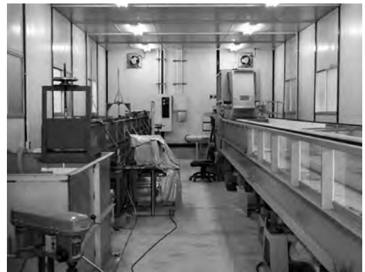
図 7.2 河川実験用水路
