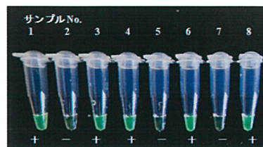
図2：LAMP法による結果の例 対象の種が存在すれば蛍光する
