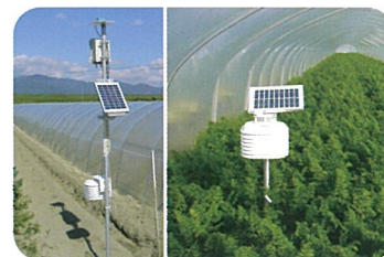
簡易施設向けICT環境モニタリング装置 左：親機、右：子機
