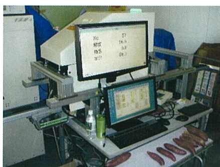
「なると金時」糖度センサーを搭載した非破壊糖度測定機
