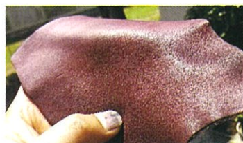
インジルビンを応用した染色法の開発 ※牛皮革を染色
