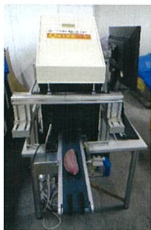
「なると金時」糖度センサーを搭載した非破壊糖度測定機
