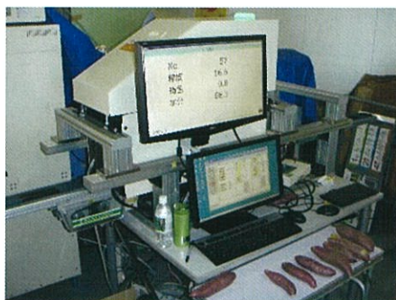
「なると金時」糖度センサーを搭載した非破壊糖度測定機
