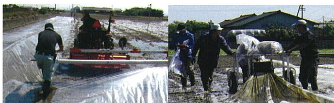
図3 開発したフィルム被覆補助具と簡易フィルム除去機
