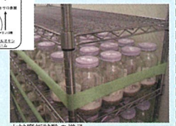
木材腐朽試験の様子
